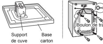
Enlever les boulons de transport et le support de cuve.
