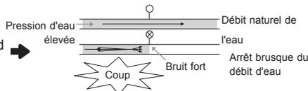
Régler la pression de l'eau en réduisant la vanne d'eau ou le robinet d'eau au domicile.
