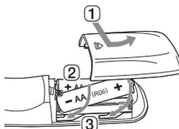
Utiliser des piles AA de 1,5 V. Remplacer les deux piles en les insérant dans la télécommande conformément aux instructions indiquées.
