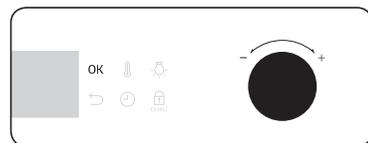
**1.** Lorsque l'élément Heure clignote, tournez le cadran des valeurs (le cadran côté droit) pour régler l'heure, puis appuyez sur **OK** pour passer sur l'élément Minute.
