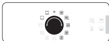
2. Tournez le sélecteur de mode pour sélectionner le mode de cuisson. Vous pouvez sélectionner le mode Gril, Convection, et Chaleur par le haut + Convection sur le compartiment supérieur et le mode Convection, Chaleur par le bas + Convection, et Chaleur par le bas sur le compartiment inférieur.
