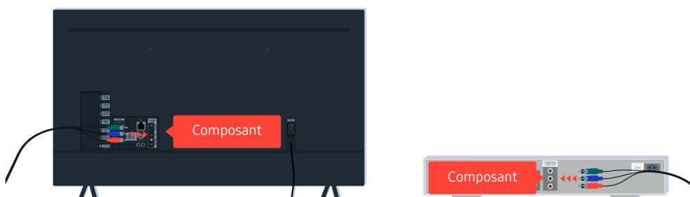
Si un câble composant est utilisé, assurez-vous que les connecteurs de couleur sont raccordés aux connecteurs correspondants de l'appareil externe et du téléviseur.
