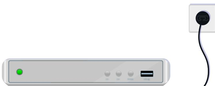
S'il ne s'allume pas, assurez-vous que le câble d'alimentation est correctement connecté à l'appareil et au secteur.
