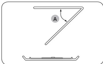
Pour nettoyer la zone supérieure du compartiment de cuisson, abaissez l'élément chauffant supérieur de 45° (A), comme indiqué. Cela permettra de nettoyer la zone supérieure. Une fois cela fait, repositionnez l'élément chauffant supérieur.
