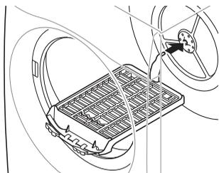
**3** Placer le support de séchage sur la structure au-dessus du filtre à peluches et appuyer dessus pour terminer l'assemblage.
