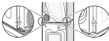
3 Aligner les trous du kit de superposition LG et les trous du capot arrière.
