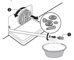
4 Après avoir nettoyé le filtre de la pompe de vidange, réinsérer soigneusement le filtre et revisser le bouchon de vidange dans le sens des aiguilles d'une montre afin d'éviter des dommages au filetage et des fuites. Réinsérer le bouchon dans le tuyau de vidange et placer le tuyau dans son support.
