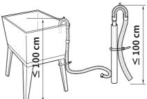
• Si le tuyau de vidange est trop long, ne pas le faire entrer de force dans l'appareil. Cela entraînerait un bruit anormal.
