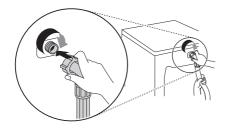
• Ne pas raccorder le tuyau à l'alimentation en eau chaude pour les modèles avec une entrée d'eau. Le raccorder à l'alimentation en eau froide uniquement.
