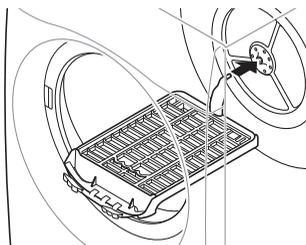
**3** Placer le support de séchage sur la structure au-dessus du filtre à peluches et appuyer dessus pour terminer l'assemblage.
