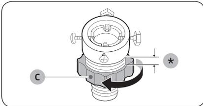
3. Maintenez l'adaptateur et tournez **la partie (C)** dans le sens de la flèche pour le desserrer de 5 mm (\*).
