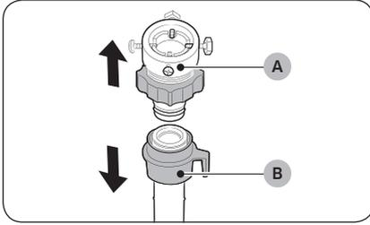
1. Retirez l'**adaptateur (A)** du **tuyau d'eau (B)**.
