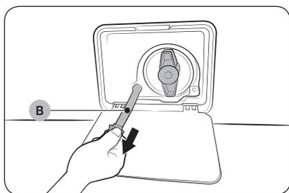
4. Ouvrez le bouchon du tuyau et laissez couler l'eau du **tuyau de vidange d'urgence (B)** dans le bac.
