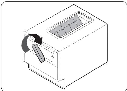
4. Lorsque l'eau gèle et se transforme en glaçons, tournez la poignée du bac à glaçons dans le sens horaire pour vider les glaçons dans le réservoir à glaçons. Recommencez la procédure jusqu'à ce que tous les glaçons aient été transférés dans le réservoir à glaçons.
