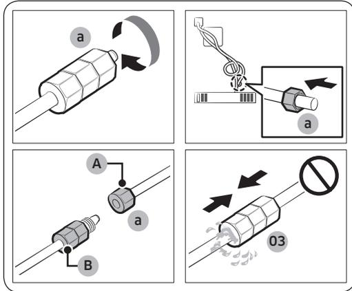
A. Tuyau d'eau de l'appareil
