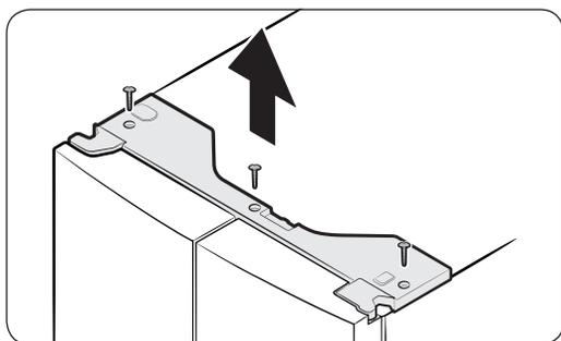
1. Après avoir fermé les portes, utilisez un tournevis cruciforme pour retirer les vis (x3) au niveau du cache supérieur. Tirez vers le haut et retirez le cache supérieur avec les connecteurs.
