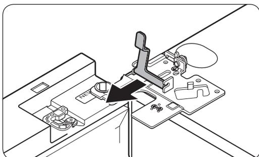
2. Débranchez les deux connecteurs de câble sur la porte gauche. La position des connecteurs diffère selon le modèle.
