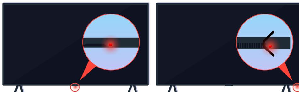
Vérifiez que le signal de la télécommande infrarouge est transmis et reçu.
