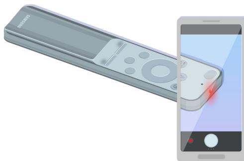
Vous pouvez vérifier si le signal est transmis en appuyant sur le bouton marche/arrêt et en observant l'avant de la télécommande à l'aide de la caméra de votre smartphone.
