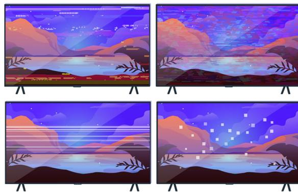
Si le problème persiste, déterminez précisément ce qu'il se passe au niveau de l'affichage. Par exemple, affichage de mosaïques et de blocs, de lignes multiples ou de points blancs, ou encore de lignes horizontales ou verticales fixes.
