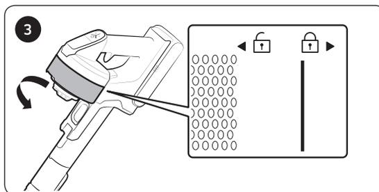
\* Lors de l'assemblage, tournez le filtre jusqu'à ce que la ligne sous l'image du cadenas ne soit plus visible.
