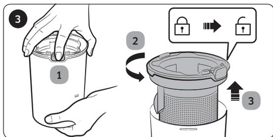
1 Tout en appuyant sur le bouton, 2 tournez le cache du réservoir de poussière et 3 retirez-le du réservoir de poussière.
