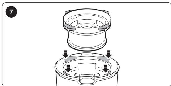
Remontez le micro-filtre lavable dans le cache du réservoir de poussière en l'insérant dans les rainures du cache du réservoir de poussière.
