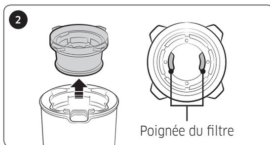
Retirez le micro-filtre lavable à l'aide des poignées du filtre à l'intérieur du micro-filtre lavable.
