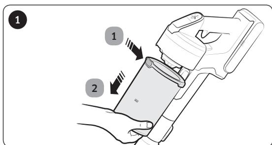
1 Après avoir appuyé sur le bouton de déverrouillage du réservoir de poussière, 2 tirez le réservoir dans la direction de la flèche.
