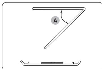
Pour nettoyer la zone supérieure du compartiment de cuisson, abaissez l'élément chauffant supérieur de 45° (A), comme indiqué. Cela permettra de nettoyer la zone supérieure. Une fois cela fait, repositionnez l'élément chauffant supérieur.
