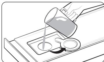
2. Ouvrez le bouchon du réservoir, et remplissez le réservoir avec 500 ml d'eau potable.
