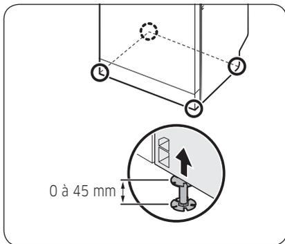
1. Tout en soulevant légèrement l'avant ou l'arrière (ou les deux à tour de rôle) du lave-vaisselle, tournez les pieds de mise à niveau pour régler la hauteur.
