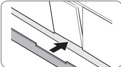
4. Fixez la plinthe au-dessous du lave-vaisselle. Vérifiez que la plinthe n'entre pas en contact avec la porte du lave-vaisselle.
