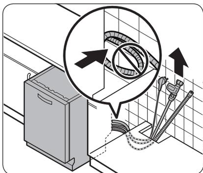
3. Faites passer la fiche d'alimentation, le tuyau d'eau et le tuyau d'évacuation dans le trou de l'évier.
