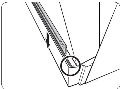
2. Retirez la bande adhésive à l'arrière de la garniture. Puis, insérez la garniture dans la rainure située dans la partie inférieure du lave-vaisselle.
