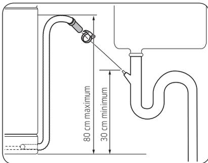
3. Insérez le tuyau d'évacuation dans le porte-tuyau de sorte que le tuyau d'évacuation soit placé entre 30 et 80 cm de la partie inférieure.
