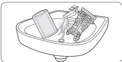
4. Éliminez la saleté et les impuretés au niveau du microfiltre et du pré-filtre.
