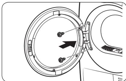
10. Insérez la charnière du hublot dans la position opposée de l'encadrement du hublot, puis serrez les 2 vis à boulon.
