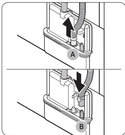
1. Retirez le tuyau de vidange au niveau de l'**orifice (A)** et insérez-le dans la **pièce (B)**.
