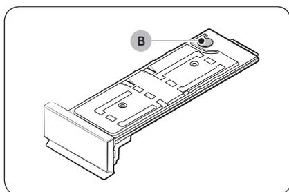
2. Videz l'eau via l'**orifice de vidage (B)**, puis nettoyez l'intérieur du réservoir d'eau.
