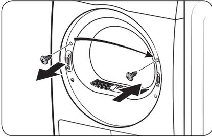
5. Retirez la vis supérieure à gauche de l'encadrement du hublot, puis insérez-la dans le trou droit correspondant de l'encadrement du hublot. Ne retirez pas les vis du support inférieur.
