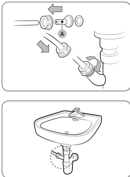
1. Assemblez le **raccord de tuyau (A)** et reliez-le à l'extrémité du tuyau fourni, comme indiqué.
