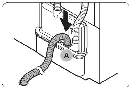
2. Insérez une extrémité du tuyau fourni (long tuyau de vidange) dans l'**orifice (A)**.
