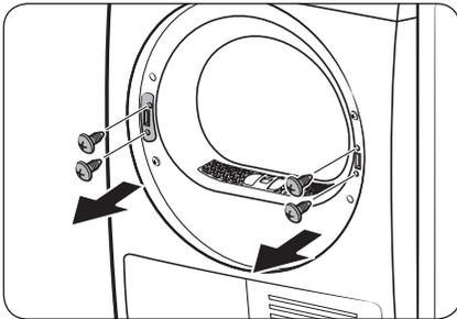
6. Retirez les 2 vis du support sur l'encadrement droit, puis retirez les 2 vis du support sur l'encadrement gauche.
