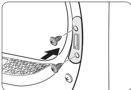
9. Insérez le support de la manette sur l'encadrement droit, puis serrez les 2 vis du support.
