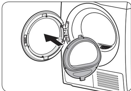
11. Insérez le support de la vitre intérieure dans le cache du hublot installé sur l'encadrement gauche.
