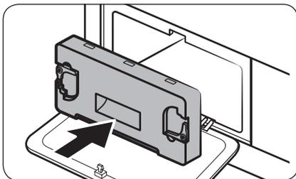
5. Réinsérez le cache intérieur dans sa position d'origine, puis verrouillez les fixations.
