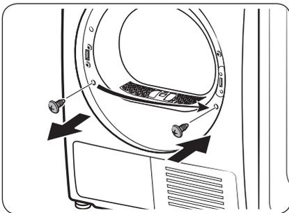
8. Retirez la vis inférieure sur l'encadrement gauche, puis insérez-la dans le trou correspondant de l'encadrement droit.
