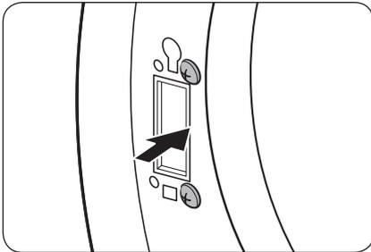
7. Insérez les 2 vis du support retirées dans l'encadrement gauche, comme indiqué.
