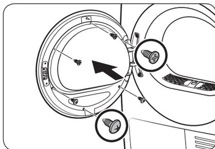
12. Serrez les 3 vis du support sur la partie supérieure. Serrez ensuite les 3 vis du support sur la partie inférieure.
