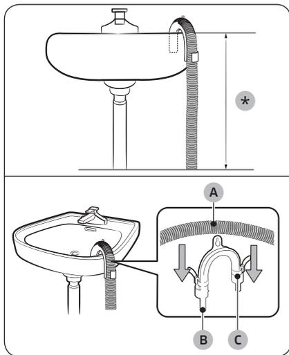
1. Assurez-vous de placer l'extrémité du tuyau fourni à moins de **90 cm (\*)** de la partie inférieure du sèche-linge.
