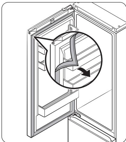
41. Détachez les joints des portes du réfrigérateur et du congélateur, puis fixez-les après une rotation de 180 degrés.
