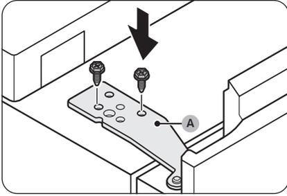
29. À l'aide d'une clé à douille (8 mm), fixez la charnière supérieure (A) avec les vis.
