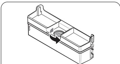
2. Remplissez le réservoir d'eau de 3,5 litres d'eau potable (MAXIMUM). Vous pouvez retirer soit le bouchon supérieur, soit le cache pour verser de l'eau.
