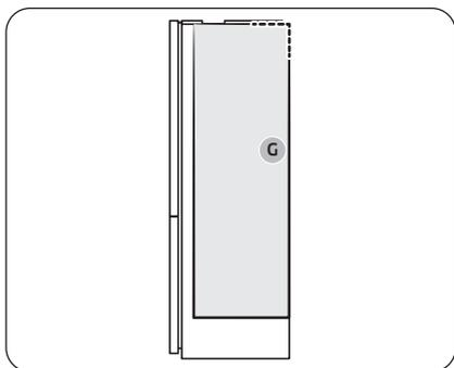
3. Installez les mousses afin de laisser un écart entre les deux réfrigérateurs.
