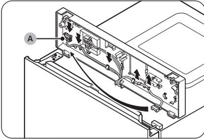
31. Sous le cache supérieur, tirez le connecteur de câble (A) des supports et déplacez-le vers les supports du côté opposé.
