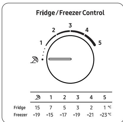
Pour activer le mode Absence, tournez la molette de commande Réfrigérateur / Congélateur sur . La température du réfrigérateur sera réglée pour rester en-dessous de 15 °C et celle du congélateur sera réglée pour rester en dessous de -19 °C.
