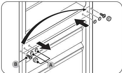
10. Retirez le cache-vis de la charnière centrale (A), puis utilisez le tournevis cruciforme pour retirer la vis (B).
