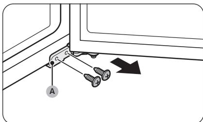
7. Ouvrez la porte du congélateur et utilisez un tournevis cruciforme pour retirer les vis maintenant en place la **charnière inférieure (A)**.
