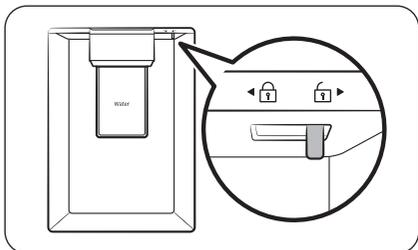
4. Posez un verre d'eau sous la sortie d'eau du distributeur, et poussez légèrement le levier du distributeur pour faire s'écouler l'eau. Assurez-vous que le distributeur d'eau est déverrouillé.
