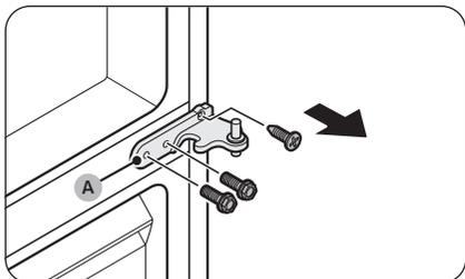
9. Utilisez un tournevis cruciforme et une clé à douille (10 mm) pour retirer les vis permettant de fixer la charnière centrale (A).
