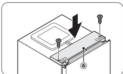
36. Avec la porte du réfrigérateur fermée, remplacez le **cache supérieur (A)** et serrez-le avec les vis à l'aide d'un tournevis cruciforme.
