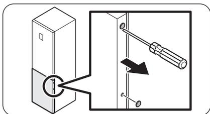
3. De l'autre côté de la porte, utilisez un tournevis à tête plate pour retirer les cache-vis.
