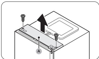
1. Après avoir fermé la porte du réfrigérateur, utilisez un tournevis cruciforme pour retirer les vis fixant le cache supérieur (A).
