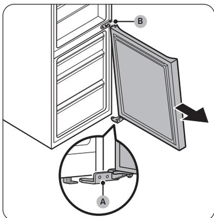
8. Alors que la porte du congélateur repose sur la **charnière inférieure (A)**, tirez lentement la **charnière inférieure (A)** pour la retirer du support situé dans la partie inférieure du réfrigérateur. Une fois la **charnière inférieure (A)** retirée du support, retirez-la de la porte du congélateur, puis tirez la porte du congélateur vers le bas pour la retirer de la **charnière centrale (B)**.
