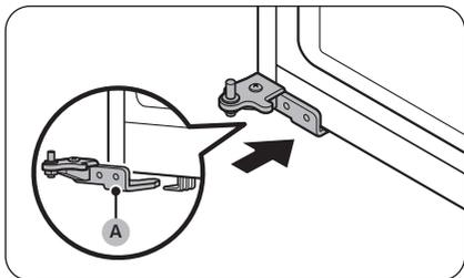
17. Tournez le pied de mise à niveau sur le côté opposé à celui où la **charnière inférieure (A)** a été retirée. Ensuite, placez la **charnière inférieure (A)** sur le support.
