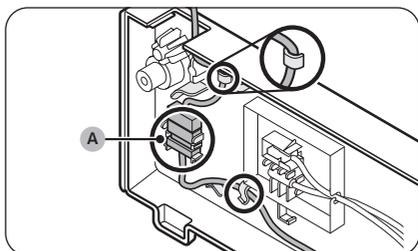
34. Placez le câble et le **connecteur de câble (A)** sur le support situé en dessous du cache supérieur.
