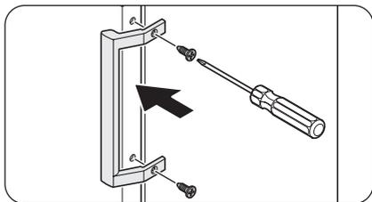
4. Placez la poignée de l'autre côté de la porte et utilisez un tournevis cruciforme pour fixer la poignée à l'aide des vis.
