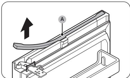
22. Retirez le cache du câble (A) de la partie supérieure de la porte du réfrigérateur.
