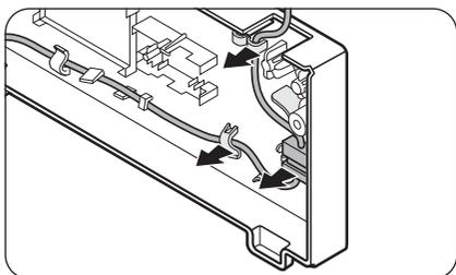
3. Retirez le câble et le connecteur de câble sur le support situé en dessous du cache supérieur.
