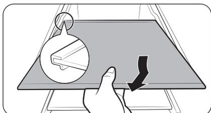
Pour obtenir plus de place, vous pouvez retirer tous les tiroirs et placer la « clayette du congélateur » sur le tiroir inférieur du congélateur, car cela n'affecte pas les caractéristiques thermiques et mécaniques de l'appareil. Le volume de stockage nominal du compartiment d'aliments surgelés est calculé sans ces tiroirs. (Dans le cas du modèle pour Singapour, le volume déclaré est calculé avec le retrait du tiroir supérieur et du tiroir du milieu uniquement.)
