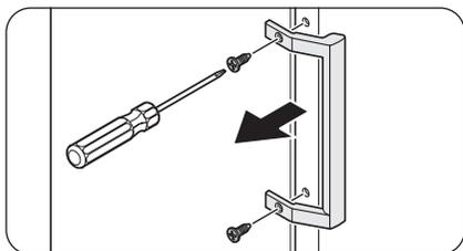
2. Utilisez un tournevis cruciforme pour retirer les vis et détacher la poignée.
