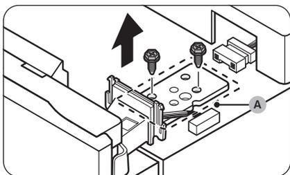
5. Utilisez une clé à douille (8 mm) pour retirer les vis permettant de fixer la **charnière supérieure (A)**.
