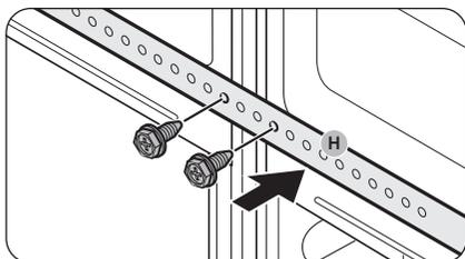
9. Utilisez les vis retirées à l'étape 8 pour fixer l'équerre arrière (H).
