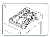
Placez la mousse de polystyrène de protection (coussin) incluse dans l'emballage sur le sol et posez le produit sur la mousse, face orientée vers le bas, comme indiqué sur l'image. En l'absence de mousse de polystyrène, utilisez un tapis épais.
