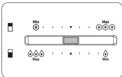
Pour fabriquer des glaçons en été (température supérieure à 35 °C), réglez la température du congélateur sur la position centrale.
