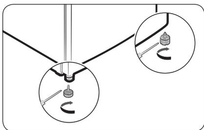
Mettez le réfrigérateur à niveau en réglant ses pieds manuellement. Tournez les pieds de mise à niveau dans le sens horaire pour abaisser l'appareil ou dans le sens antihoraire pour le relever. Pour des raisons de sécurité, le côté avant doit être légèrement plus élevé que le côté arrière.
