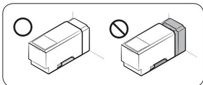
3. Réinsérez le réservoir d'eau et fixez-le dans le mécanisme de distribution. Assurez-vous que le couvercle sur le capot est orienté face devant.
