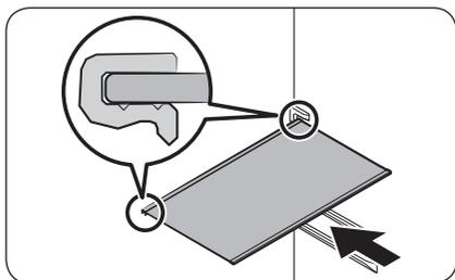
Avant d'insérer la clayette, vérifiez la forme de la partie arrière de la clayette. Ensuite, insérez la clayette en procédant dans l'ordre inverse de la procédure de retrait.
