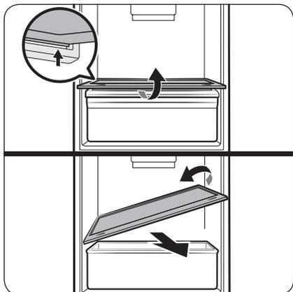
Maintenez la clayette à légumes avec les deux mains et soulevez-la pour la retirer du crochet arrière. Ensuite, inclinez-la sur un côté et tirez pour la retirer.
