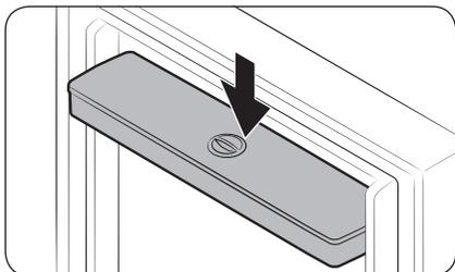
3. Réinsérez le réservoir d'eau et fermez la porte. Assurez-vous que la sortie d'eau du réservoir d'eau soit orientée vers l'avant.
