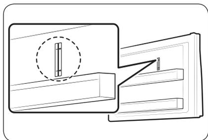
Une ligne indiquant la limite de charge est apposée sur la partie supérieure droite du compartiment congélateur.
