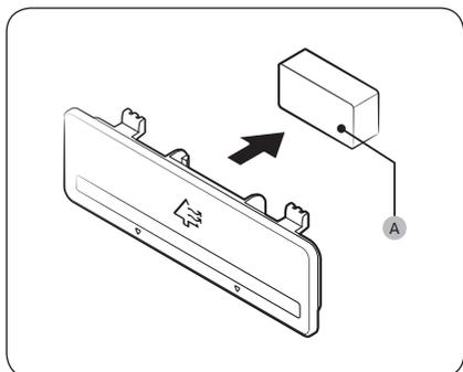
Tenez les côtés supérieur et inférieur du logement du filtre et déverrouillez-le pour que le **filtre désodorisant (A)** devienne visible. Remplacez le filtre, puis réinsérez le logement.
