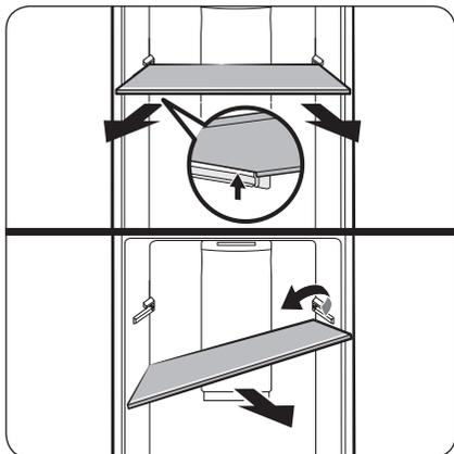
Pour retirer la clayette, tenez-la avec les deux mains et soulevez-la pour la retirer du crochet arrière. Ensuite, inclinez-la sur un côté et tirez pour la retirer.
