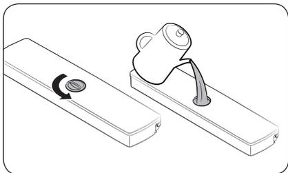
2. Remplissez le réservoir d'eau avec de l'eau potable. Retirez le bouchon et versez de l'eau.
