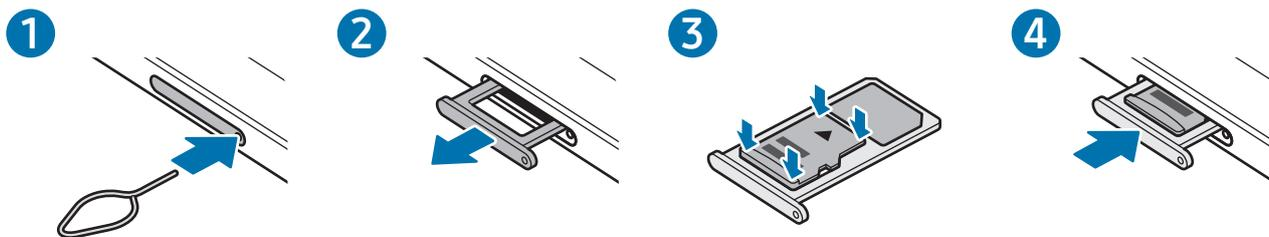
1 Insérez l'outil de retrait à l'endroit prévu à cet effet sur le compartiment pour le déverrouiller.
