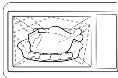
1. Les micro-ondes générées par le magnétron sont réfléchies sur les parois du four et réparties de façon homogène à l'intérieur du four pendant la cuisson grâce à la rotation du plateau sur lequel sont placés les produits. Ce procédé assure donc une cuisson homogène des aliments.
