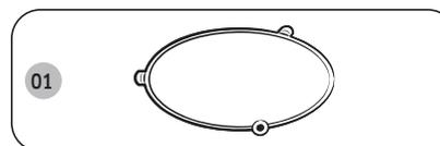
**01 Anneau de guidage**, à placer au centre du plancher du four. L'anneau de guidage sert de support au plateau.
