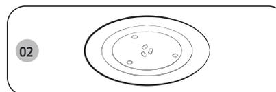
**02 Plateau tournant**, à placer sur l'anneau de guidage en enclenchant la partie centrale sur le coupleur. Ce plateau constitue la principale surface de cuisson ; il peut être facilement retiré pour être nettoyé.
