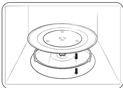
Retirez tout élément d'emballage de l'intérieur du four à micro-ondes. Installez l'anneau de guidage et le plateau. Vérifiez que le plateau tourne librement.
