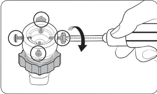
2. Utilisez un tournevis cruciforme pour desserrer les quatre vis de l'adaptateur.
