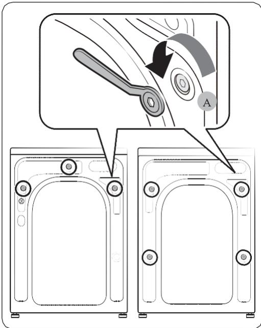
1. Repérez les boulons de transport (entourés sur l'illustration) situés à l'arrière du lave-linge.
