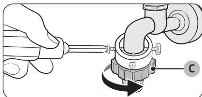
4. Insérez l'adaptateur sur le robinet d'eau, puis serrez les vis tout en soulevant l'adaptateur.
