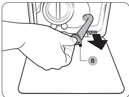
3. Placez un grand bac vide autour du cache et tirez le tuyau de vidange d'urgence jusqu'au bac, tout en maintenant en place le **bouchon du tuyau (B)**.
