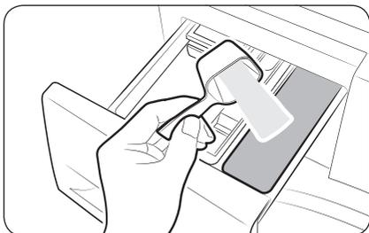
4. Pour effectuer un pré-lavage, versez une dose de lessive de pré-lavage dans le **1** **compartiment de pré-lavage** en suivant les instructions ou recommandations du fabricant.
