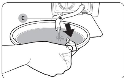
4. Ouvrez le bouchon du tuyau et laissez l'eau s'écouler du **tuyau de vidange d'urgence (C)** dans le bac.
