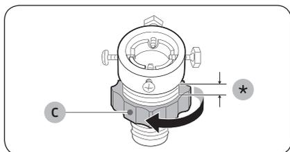
3. Maintenez l'adaptateur en place et tournez la **partie (C)** dans le sens de la flèche pour le desserrer de 5 mm (\*).
