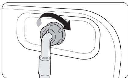
2. Raccordez l'autre extrémité du tuyau d'eau à la vanne d'arrivée d'eau située à l'arrière du lave-linge. Tournez le tuyau dans le sens horaire pour le serrer.
