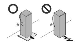
Après avoir installé l'appareil, branchez la fiche d'alimentation dans une prise de courant et mettez-le sous tension.
