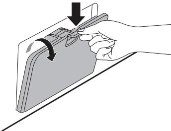
3 Retirer d'abord le bouchon de vidange du tube de vidange, puis vider l'eau.
