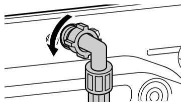
**2** Retirer le filtre d'arrivée d'eau avec une petite pince et nettoyer le filtre à l'aide d'une brosse à dents à poils medium.
