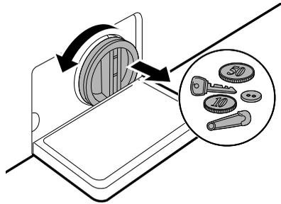
5 Après avoir nettoyé le filtre de la pompe de vidange, réinsérer soigneusement le filtre et revisser le bouchon de vidange dans le sens des aiguilles d'une montre afin d'éviter des dommages au filetage et des fuites. Réinsérer le bouchon dans le tuyau de vidange et placer le tuyau dans son support.
