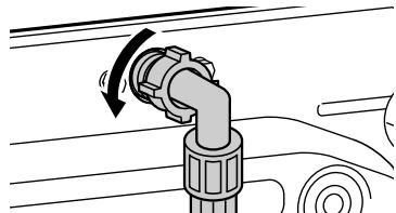
**2** Retirez le filtre d'arrivée d'eau avec une petite pince et nettoyez le filtre à l'aide d'une brosse à dents à poils medium.
