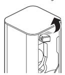
2 Pour insérer, positionnez la batterie pour l'ajuster avec les bords du chargeur de batterie.
