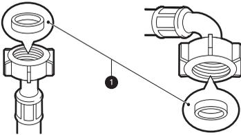
**Raccordement du tuyau au robinet d'eau****Raccordement d'un tuyau de type vissé à un robinet**
