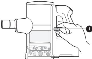
**3** Appuyez sur le bouton de déverrouillage du couvercle du bac à poussière **2** pour l'ouvrir. Secouez le bac à poussière pour le vider.
