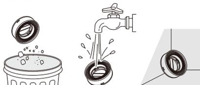
5. Alignez le filtre d'évacuation à la position ouverte et faites-le tourner dans le sens des aiguilles d'une montre pour être à la position verrouillée ❹ et assemblez-le au corps du produit.
