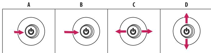
**A (Sous tension) :** Appuyez une fois sur le bouton du joystick pour allumer le moniteur.
