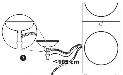
des inondations. L'utilisation du raccord du tuyau de vidange permet d'éviter un siphonnage, des odeurs ou un drainage inapproprié.
