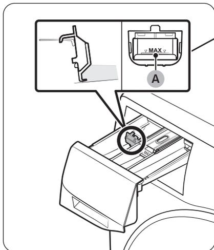
Insérez d'abord le bac à lessive liquide fourni dans le **II compartiment de lavage principal**. Versez ensuite de la lessive liquide dans le bac en veillant à ne pas dépasser le **trait de remplissage maximum (A)**.
