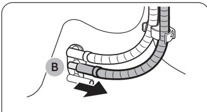
2. Retirez le tuyau de vidange du réservoir d'eau au niveau du **support (B)**, puis raccordez-le à la **sortie d'eau de vidange (A)**.
