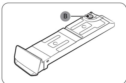
2. Videz l'eau via l'**orifice de vidange (B)**, puis nettoyez l'intérieur du réservoir d'eau.
