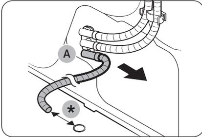
1. Retirez le long tuyau de vidange au niveau de la **sortie d'eau de vidange (A)**.
