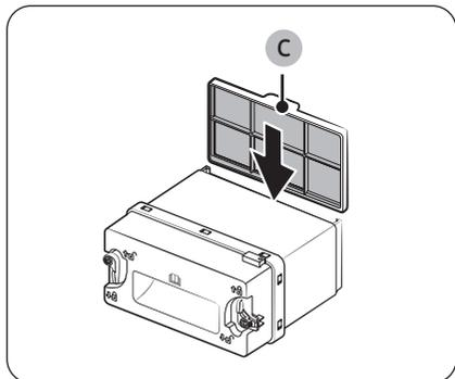
3. Insérez le **microfiltre souple (filtre en option) (C)** fourni à l'arrière du cache interne, comme illustré.
