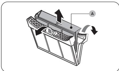
2. Ouvrez le filtre extérieur et retirez le **filtre intérieur (A)**.
