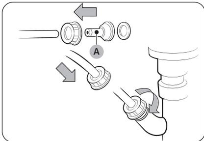
1. Assemblez le **raccord de tuyau (A)** et reliez-le à l'extrémité du tuyau fourni, comme indiqué.
