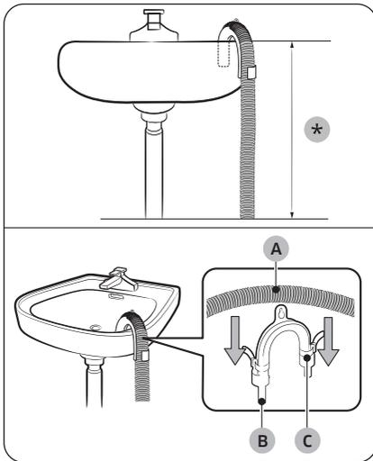
2. Insérez une extrémité du tuyau fourni (long tuyau de vidange) dans la **sortie d'eau de vidange (A)**.
