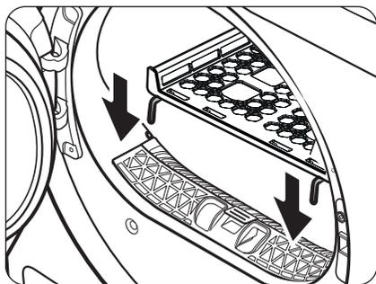
1. Placez la grille de séchage dans le tambour, en insérant les rebords avant de la grille dans les trous du diaphragme du hublot.
