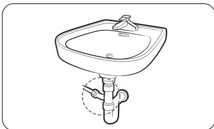
2. Raccordez directement l'adaptateur de tuyau au tuyau de vidange du lavabo.
