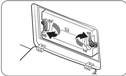
4. Réinsérez le cache intérieur dans sa position d'origine, puis verrouillez les fixations.
