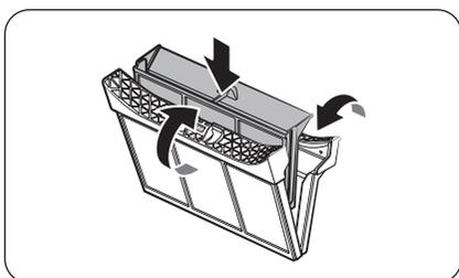
5. Placez le filtre intérieur dans le filtre extérieur, puis réinsérer le filtre à peluches dans sa position d'origine.
