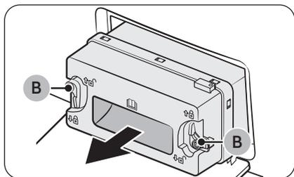
2. Déverrouillez les **dispositifs de fixation (B)** du cache intérieur, puis tirez le cache intérieur pour le retirer.
