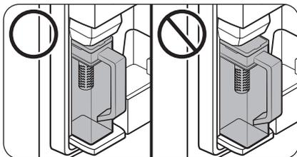
3. Activer la fonction AutoFill Pitcher (Carafe à remplissage automatique) sur le panneau principal. Ouvrez la porte du centre de boissons (type A) ou la porte gauche du réfrigérateur (type B), puis insérez la carafe d'eau sur le support. Pressez-le bien droit pour l'insérer, comme indiqué sur l'illustration.
