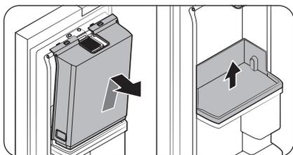
3. Si les colliers Snap-Joint sur la partie supérieure sont détachés, maintenez le **cache de la Zone des boissons** et soulevez-le pour le retirer.
