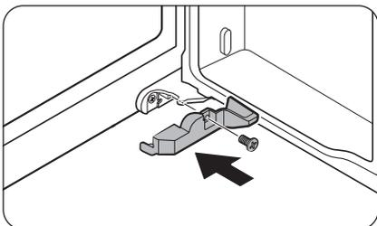
4. Fixez le cache à l'aide d'un tournevis cruciforme. Veillez à ne pas endommager et à ne pas marcher sur les connecteurs.
