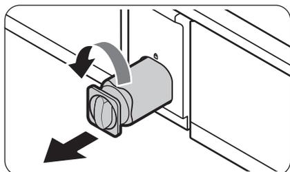
3. Faites tourner le bouton de la cartouche du filtre dans le sens antihoraire et de 90 degrés ( $\frac{1}{4}$  de tour). La cartouche du filtre se déverrouille.
