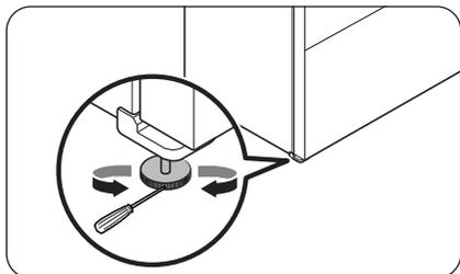
Insérez un tournevis à tête plate dans la vis de mise à niveau du pied avant gauche ou droit. Faites tourner la vis de mise à niveau dans le sens horaire pour remonter le pied ou dans le sens antihoraire pour l'abaisser.
