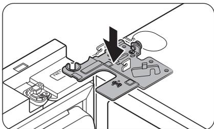
2. Mettez la charnière supérieure en position en haut du réfrigérateur, puis insérez l'axe de la charnière dans l'orifice supérieur de la porte. Assurez-vous que les câbles au niveau de la porte passent à travers l'orifice dans l'axe de la charnière.
