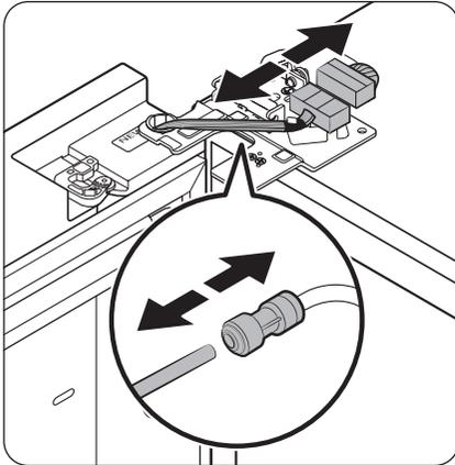
2. Débranchez les deux connecteurs de câble sur la porte gauche. La position des connecteurs diffère selon le modèle.
