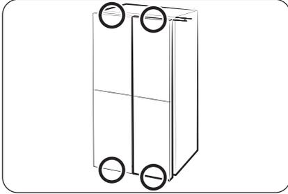
Vous pouvez régler l'écart entre les quatre portes et le corps principal du réfrigérateur à l'aide de la molette de réglage. (Reportez-vous à l'illustration pour connaître l'emplacement de la molette de réglage.)
