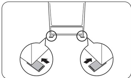
Si vous devez rehausser l'arrière du réfrigérateur pour le mettre de niveau, vous pouvez utiliser le (ou les) patins de mise à niveau fournis. Suivez les instructions pour rehausser l'arrière du réfrigérateur.
