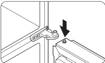
2. Tout en appuyant sur l'axe de la charnière, placez la porte de manière à ce que l'axe de la charnière soit en-dessous de l'orifice de l'axe dans la charnière centrale. Relâchez l'axe de la charnière afin qu'il pénètre dans l'orifice de l'axe.
