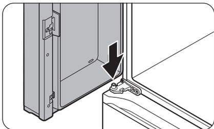
1. Tout en maintenant la porte ouverte à plus de 90 degrés, insérez l'axe de la charnière centrale dans l'orifice en bas de la porte.
