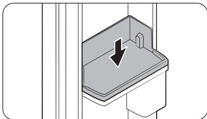
1. Une fois la porte du réfrigérateur ou la **porte vitrine** ouverte, alignez les rainures sur les côtés gauche et droit du bac inférieur de la porte, puis insérez-le.
