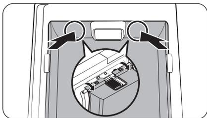
2. Une fois la **porte vitrine** gauche ouverte, ouvrez la porte du réfrigérateur. Ensuite, pressez la partie supérieure de la **Zone des boissons** (côtés gauche et droit du ventilateur) depuis l'intérieur pour détacher les colliers Snap-Joint fixant le cache de la **Zone des boissons** à la porte.
