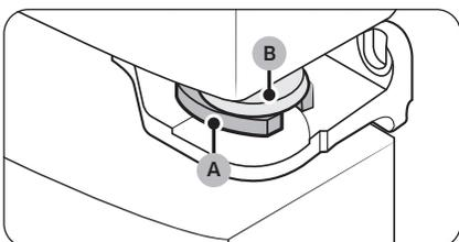
2. Insérez un circlip (A) de taille adaptée entre l'œillet de la porte (B) et la charnière, comme indiqué.
