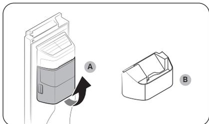
Si vous n'utilisez pas la machine à glaçons et que vous avez besoin de plus de place, retirez le **bac de la machine à glaçons (A)**. Ensuite, insérez le **guide du congélateur (en option) (B)** à la place du bac de la machine à glaçons.
