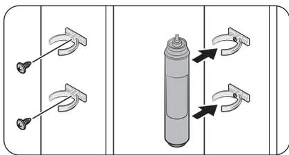
1. Attachez les **clips de sécurité** (x2) sur les positions appropriées, en dessous de l'évier par exemple. Ensuite, fixez fermement les **clips de sécurité** à l'aide de vis.
