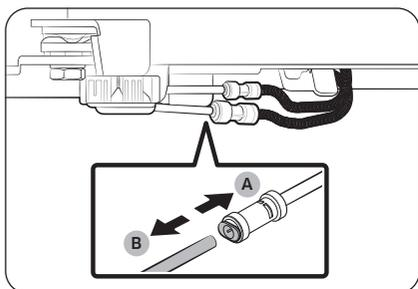
2. Pour débrancher les flexibles, maintenez la pince (A) enfoncée et détachez le tuyau d'eau (B).
