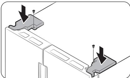
8. Insérez les caches des charnières par l'avant en premier, puis serrez les vis. Utilisez un tournevis cruciforme pour cette opération.
