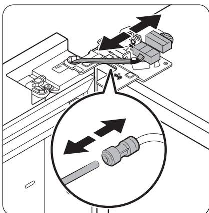
4. Débranchez les deux connecteurs de câble sur la porte gauche. La position des connecteurs diffère selon le modèle.
