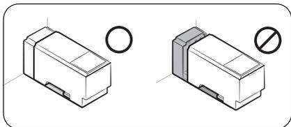
3. Réinsérez le réservoir d'eau et fixez-le dans le mécanisme de distribution. Assurez-vous que le côté avant (avec le couvercle avant) du réservoir est orienté vers l'avant.
