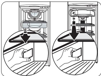
Vérifiez que la paroi de l'appareil est propre et sèche, puis fixez l'étiquette de température comme illustré sur la figure.
