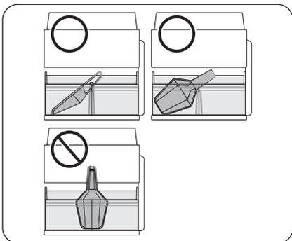
Rangez la pelle sur la partie avant du bac à glaçons. Placez la pelle comme illustré, en veillant à ce qu'elle n'interfère pas avec le distributeur de glaçons lors de l'insertion du distributeur du bac à glaçons.
