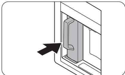
3. Activez la fonction AutoFill Pitcher (Carafe à remplissage automatique) sur le panneau de commande. Ouvrez la porte du centre de boissons, puis insérez la carafe d'eau sur le support. Pressez-le bien droit pour l'insérer, comme indiqué sur l'illustration.
