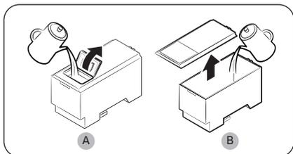
2. Ouvrez le couvercle avant (A) du capot ou le capot entier (B), puis remplissez le réservoir d'eau (5 litres d'eau maximum).
