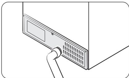
Pour maintenir la propreté des cordons et des pièces exposées du panneau arrière, passez un coup d'aspirateur sur le panneau une ou deux fois par an.
