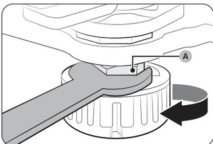
2. À l'aide d'une clé de 19 mm (fournie), faites tourner l'**écrou de blocage (A)** dans le sens horaire pour le desserrer. Ensuite, ouvrez la porte et effectuez les réglages suivants à l'intérieur.
