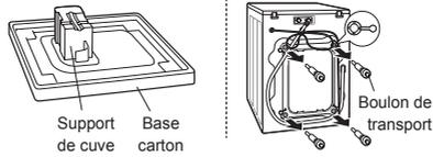
Enlever les boulons de transport et le support de cuve.
