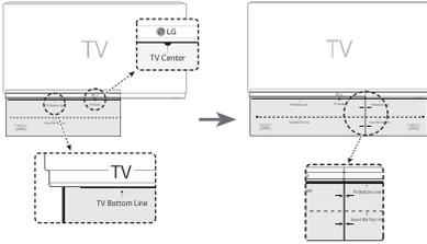
2. Si vous fixez la barre de son sur un mur en béton, utilisez des chevilles. Vous devrez percer des trous. Un feuillet de guide (un guide d'installation du support mural) est fourni pour forer. Utilisez-le pour marquer les points où percer.
