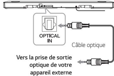
1. Raccordez la prise d'entrée OPTICAL IN à l'arrière de l'appareil à la prise de sortie optique de votre appareil externe.
