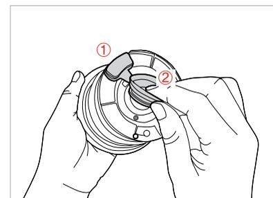
Le revêtement en silicone peut être retiré pour le nettoyage. Après le nettoyage remettez le revêtement en silicone comme indiqué dans l'illustration.
