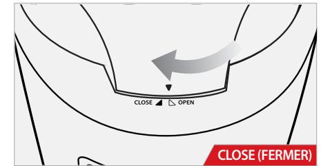
Notes | L'extracteur ne fonctionnera pas si la flèche vers le bas du tube d'embouchure n'est pas alignée avec la marque CLOSE du bloc moteur.
