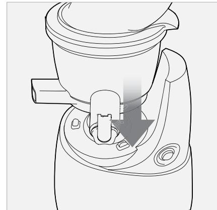
**6** Marques d'ouverture et de fermeture sur le bloc supérieur.
