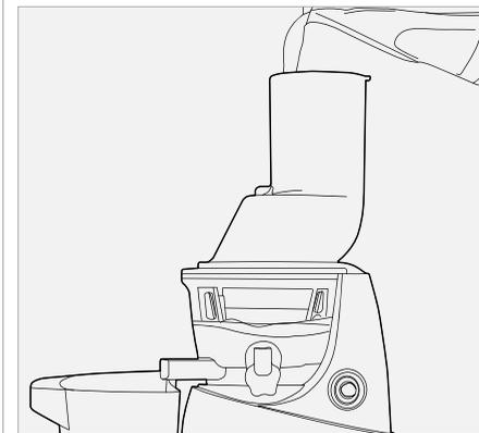
**2** Laissez-le en marche un moment. Ouvrez le bouchon et laissez s'écouler l'eau du bol d'extraction.
