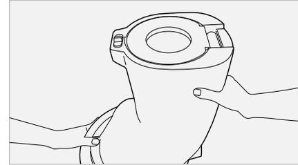
**5** Placez le couvercle sur le bol d'extraction. Alignez les flèches sur le couvercle avec la marque OPEN (OUVRIR) sur la base et tournez vers la position CLOSE (FERMER).
