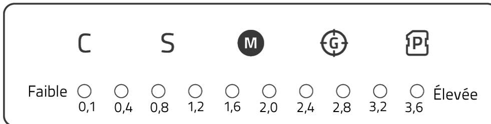
4. Appuyez sur n'importe quelle touche alphanumérique pour tester le réglage actuel. Lorsqu'une touche est enfoncée, les indicateurs LED s'allument de gauche à droite pour indiquer à quelle profondeur vous devez appuyer sur une touche pour l'actionner complètement.
