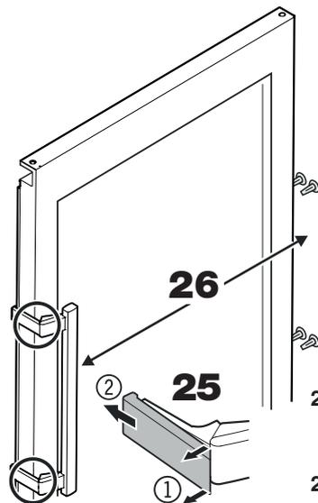
25. Désenclencher les plaques de pression à l'avant ① et les retirer vers l'arrière ②.
