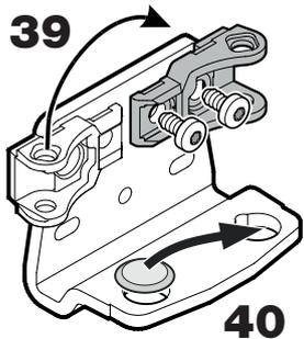
39. Poser le support pour l'amortisseur de fermeture sur le côté opposé du support.
