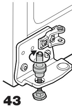
43. Mettre en place le pied réglable par en dessous et visser le pivot.
