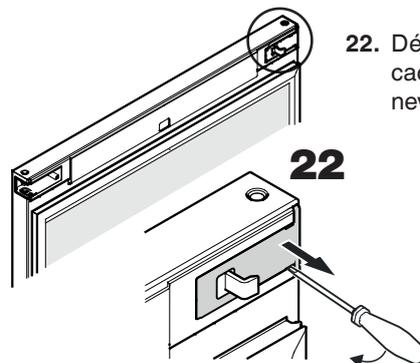
22. Déclipser et retirer le cache à l'aide d'un petit tournevis.
