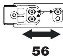
56. Desserrer les vis et déplacer le support vers la droite ou la gauche. Serrer les vis à fond.
