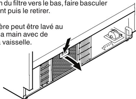
5. Sécher le filtre et le réinstaller en exécutant la procédure dans l'ordre inverse.
