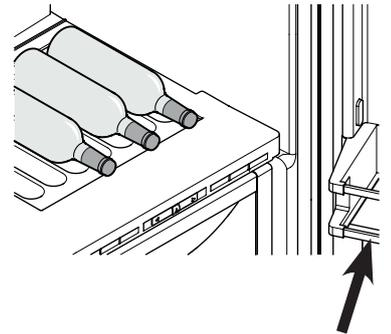
Pour ranger de grandes bouteilles, le balconnet inférieur doit être monté dans une position plus haute.
