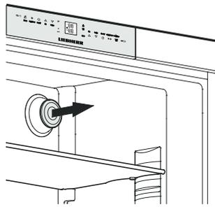
2. Insérer le filtre et le tourner à 90° dans le sens horaire.
