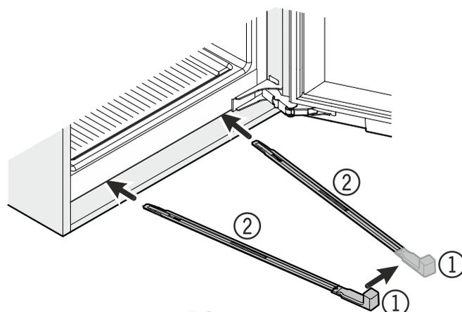
Vérifier que l'appareil est correctement fixé et sécurisé dans le corps du meuble et que la porte ferme bien.
