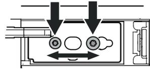
24. Desserrer les vis et déplacer le support vers la droite ou la gauche.
