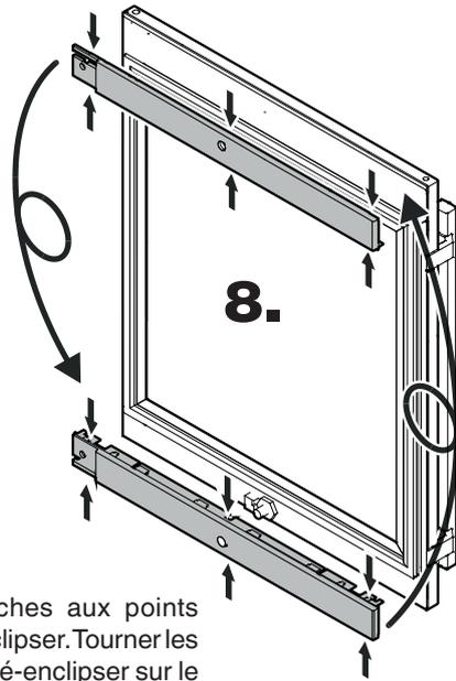
8. Appuyer sur les caches aux points indiqués et les déclipser. Tourner les caches à 180° et les ré-enclipser sur le côté opposé.
