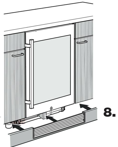
**8.** Mettre la plinthe en place. Ce faisant, la pièce moulée en mousse est repoussée vers l'arrière dans sa position définitive.
