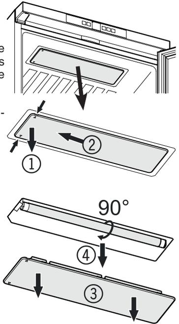
Mettre en place et faire pivoter de 90° la nouvelle lampe fluorescente.
