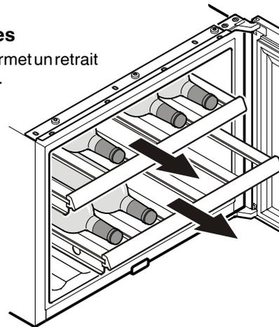
Les grandes bouteilles de vin peuvent être posées sur les clayettes en bois en travers également. Pour que les bouteilles restent bien stables, enclencher les plaques de retenue sur la barre centrale de la clayette en bois.
