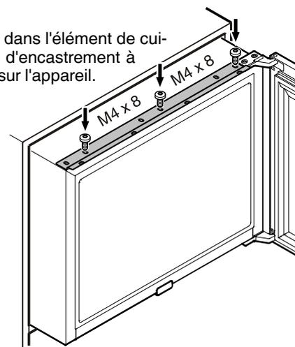
4. Introduire l'appareil dans la niche jusqu'à ce que l'écart entre le corps du meuble et la face avant de la porte soit de 21 mm.
