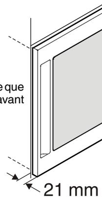
5. Puis fixer l'appareil à l'aide de vis à panneaux de particules 3,5 x 17 à travers l'équerre supérieure.
