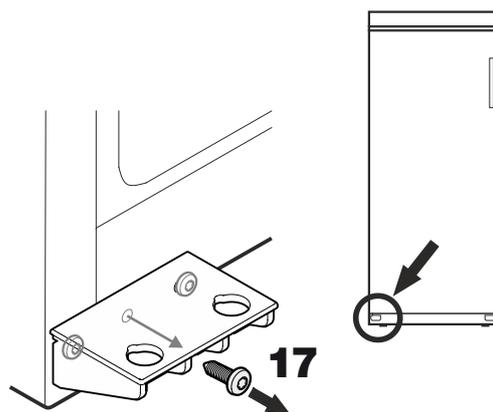
17. Dévisser la vis centrale du support. Cette vis n'est plus nécessaire.
