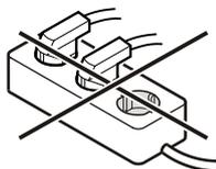
Ne pas utiliser d'onduleurs (conversion du courant continu en courant alternatif ou triphasé) ou de fiches économie d'énergie. Risque d'endommagement du système électronique!
