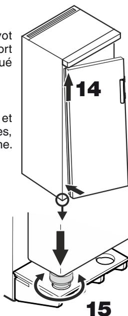
16. Réintroduire la vis dans le pivot et la resserrer.
