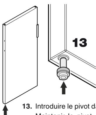
13. Introduire le pivot dans le palier gauche de la porte. Maintenir le pivot enfoncé avec l'index pendant le montage de la porte.
