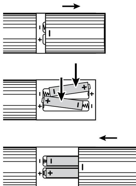
Ouvrez le couvercle de la télécommande et insérez 2 piles AAA dans le compartiment. Le diagramme polaire de la position correcte des piles est indiqué à l'intérieur du compartiment des piles.
